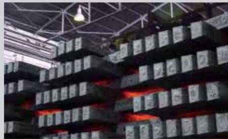
gestellt werden. Eine anschließende Prüfung auf Oberflächenrisse und Innenfehler stellt sicher, dass kein Teil bei der weiteren Verarbeitung oder womöglich am Ende im Fahrzeug ausfällt.
