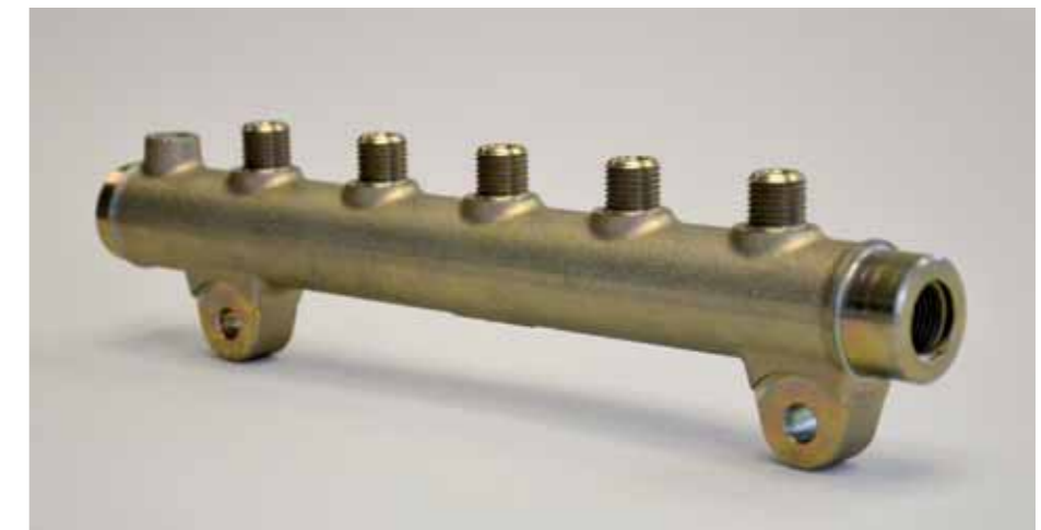
Bild 3: Rail für die Common-Rail-Einspritzung eines Dieselmotors
