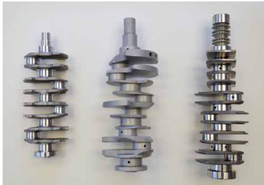
Bild 1: Vom Reihen-Vierzylinder über Sechszylinder Boxer bis hin zum V8-Hochleistungs-Motor: Kurbelwellen aus AFP-Stählen kommen in verschiedensten Motoren zum Einsatz.
