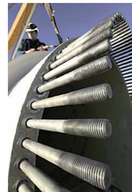
Einsatz findet der Stahl u.a. bei der Verschraubung der Rotorblätter
