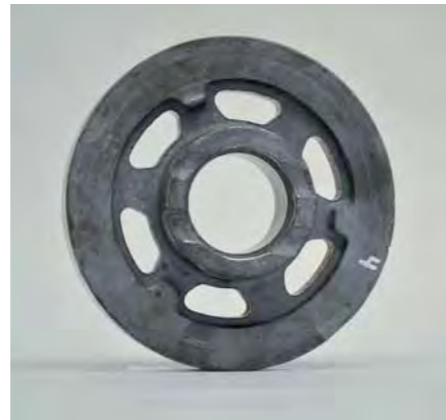
Gangrad (Zwischenprodukt) - SAE5120H (20CrS4)
