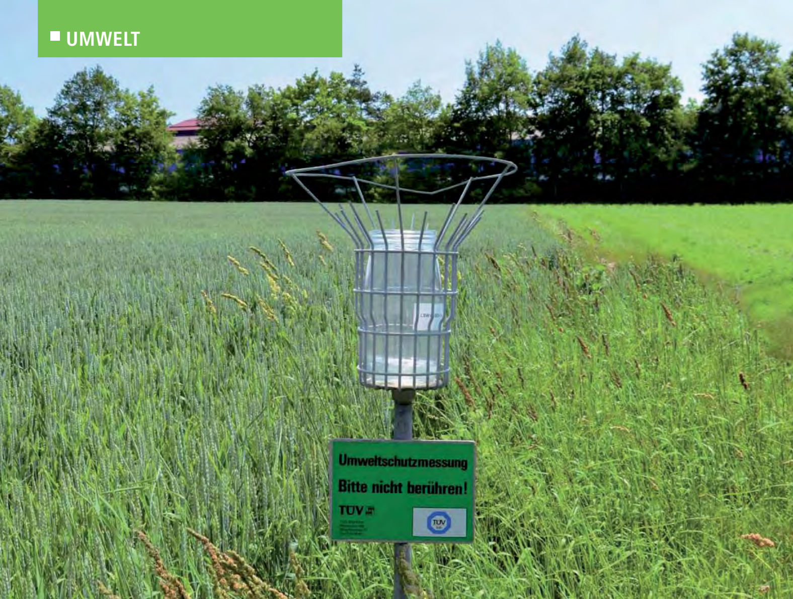
Bergerhoff-Messgefäß zur Durchführung von Depositionsmessungen
