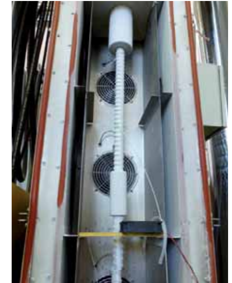
Tieftemperaturstahl bei der Entwicklung im Test bis -165 Grad Celsius
