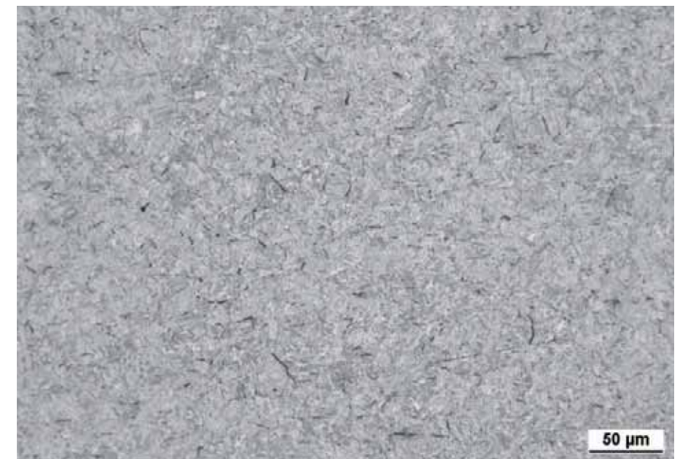
Bild 6: Ck45; gehärteter Zustand; Gefüge bestehend aus nadeligem Martensit (Bild 1, Markierung 2)
