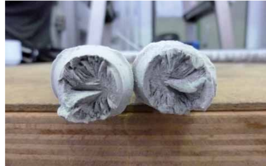
Bruchbild SAS 500/600 bei -165° C – Einschnürung zeigt hohe Duktilität
