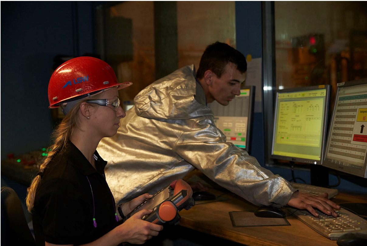
KUKA-Applikationsingenieure unterstützen die LSW-Mitarbeiter zur Inbetriebnahme und Programmierung vor Ort im Stahlwerk; Bild: KUKA Roboter GmbH
